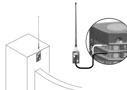
Une antenne déportée, de plus longue portée peut remplacer l'antenne fil. Elle se place sur le haut du pilier, elle doit être dégagée.
