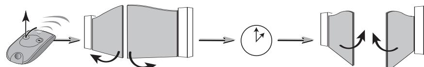
Il est possible de maintenir le portail en position ouverte par un appui bref sur la touche de la télécommande durant la temporisation.
