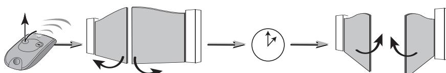
Se puede mantener la canela en posición abierta pulsando brevemente la tecla del mando a distancia durante la temporización.
