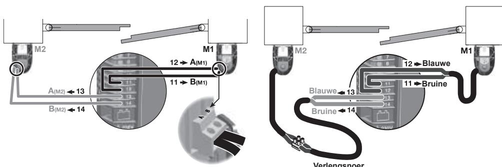
Motor M1 drijft de **rechtermotor** aan, die als eerste geopend en als laatste gesloten wordt.
