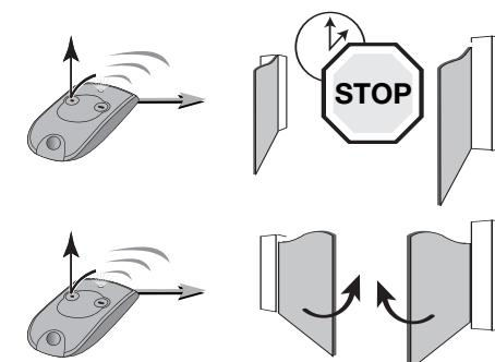
Un nouvel appui sur la touche de la télécommande provoque le fermeture du portail.
