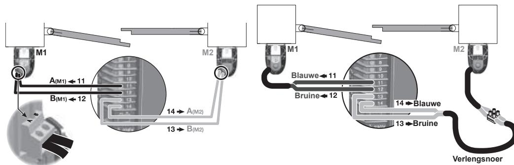
Motor M1 drijft de **linkervleugel** aan, die als eerste geopend en als laatste gesloten wordt.
