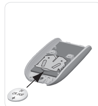
[4]. Remplacez la pile (3V CR 2430).
