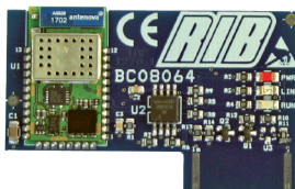
APP8064 WLAN-Modul für APP+-Karte Verwalten des Steuerung über das lokale Wi-Fi-Netzwerk (WLAN)
