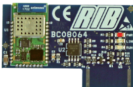
APP8064 Module Wi-Fi pour Carte APP+ pour gérer le tableau de contrôle via un réseau Wi-Fi local (WLAN)
