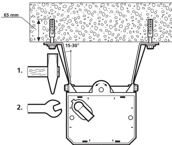
Antriebsgehäuse mit Führungsschiene so abhängen, daß Toroberkante am höchstem Punkt der Öffnungsbahn 10 mm unterhalb der Führungsschieneunterkante liegt (siehe Pkt. 6 und 7). Deckenverankerung nach baulichen Gegebenheiten vornehmen (Maßangabe für Dübelbohrung beachten).
