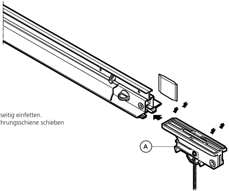
Gleitbahnen des Führungsschlitten allseitig einfetten.
