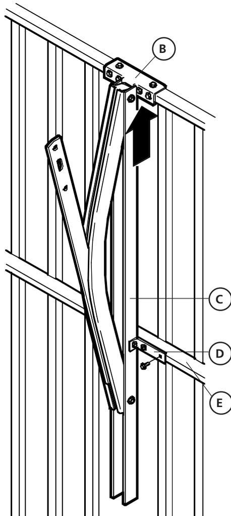
Kurventorarm (C) in Befestigungswinkel (B) stecken und mit zwei Winkelblechen (D) auf Torverstrebung (E) verschrauben.
