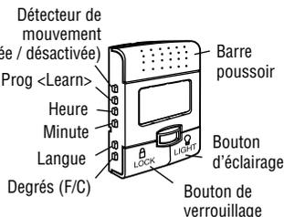
Cette console de commande contient un détecteur de mouvement, le témoin duquel s'allumera dès la détection de l'entrée d'une personne dans la garage.
