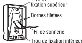
Figure 5 Connexions de commande de porte
