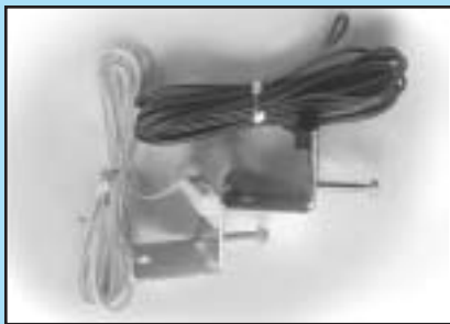
FIG. 1-10 Identifier les butées de fin de course / introduire les vis de réglage.
