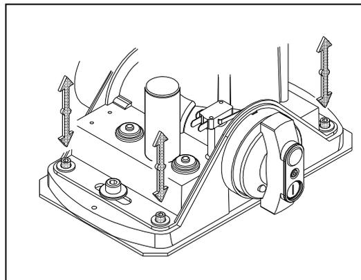
. Fijar el automatismo a la base atando fuertemente los tornillos allen de fijación.
