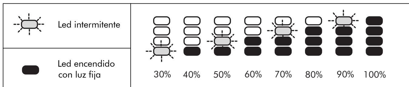
3. Pulsar SEL hasta obtener la configuración de los leds correspondientes al valor de fuerza deseado.
