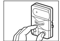
3. Maintenir les deux boutons enfoncés tout en appuyant sur le bouton-poussoir de la commande avec détecteur de mouvement (les trois boutons sont enfoncés).
