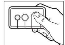
2. Tout en maintenant le bouton de la télécommande enfoncé, appuyer et tenir le bouton LIGHT de la commande avec détecteur de mouvement.
