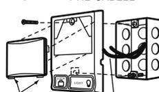
Pour remettre le couvercle en place, insérer les languettes inférieures en premier
