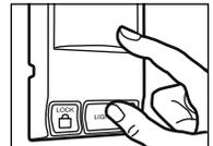
4. Relâcher les boutons lorsque l'éclairage du moteur clignote. Il a appris le code. Si les ampoules ne sont pas posées, deux clics se feront entendre.
