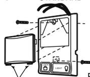
Pour remettre le couvercle en place, insérer les languettes inférieures en premier
