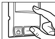
4. Relâcher les boutons lorsque l'éclairage du moteur clignote. Il a appris le code. Si les ampoules ne sont pas posées, deux clics se feront entendre.
