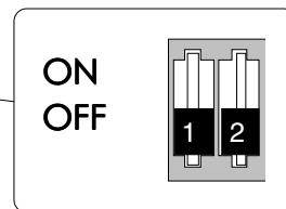
«1 OFF» "Uomo presente", funzionamento del cancello mantenendo premuto il pulsante (esclude la funzione del radiocomando) disattivato; (1 ON - attivato)
