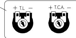
Trimmer T.L. = Regolazione tempo di lavoro da un minimo di 5 secondi a un massimo di 50 secondi.
